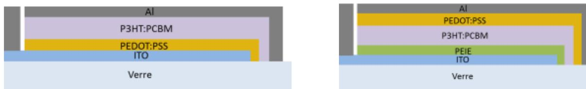
**Figure 1 : Schéma représentatif des différentes structures OPV a) structure classique b) structure inverse.**
